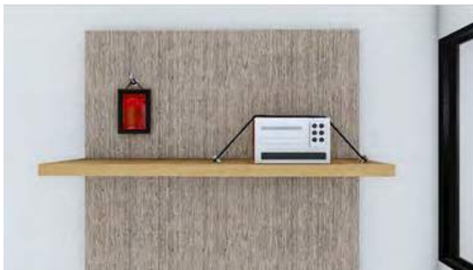
Gambar 7. Komponen non-struktur harus diberi pengaku
